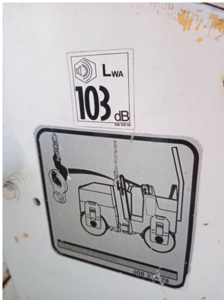
Poziom energii akustycznej oraz punkty mocowania zawiesi
