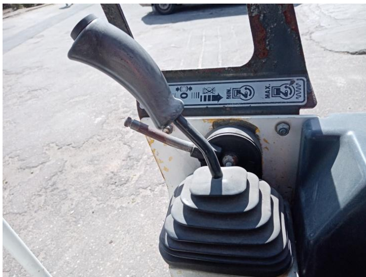
Dźwignia zmiany kierunku jazdy z przyciskiem załączającym wibrację.
