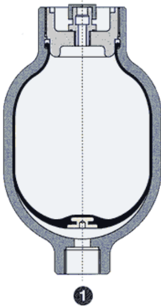
1-przekrój akumulatora hydraulicznego
