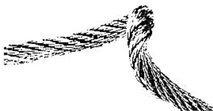
Supły lub zaciśnięte pętle wskutek zapętlenia liny
