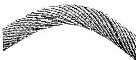
Zapętlenie liny, która została napięta bez możliwości jej obrócenia wokół własnej osi
