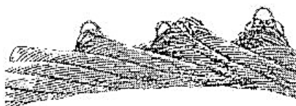
Wyciśnięcie splotki i wyciśnięcie drutu
