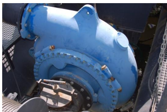
Pompa ssąca z włazem rewizyjnym, układ napędu pompy ssącej.
