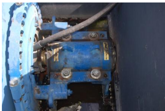
Pompa ssąca z włazem rewizyjnym, układ napędu pompy ssącej.
