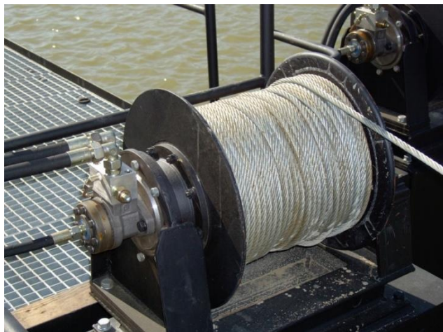
Zbiornik na olej hydrauliczny, silnik hydrauliczny napędu wciągarki.
