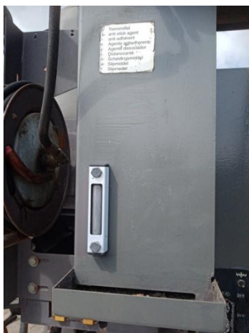
Zbiornik na olej hydrauliczny, silnik hydrauliczny napędu wciągarki.
