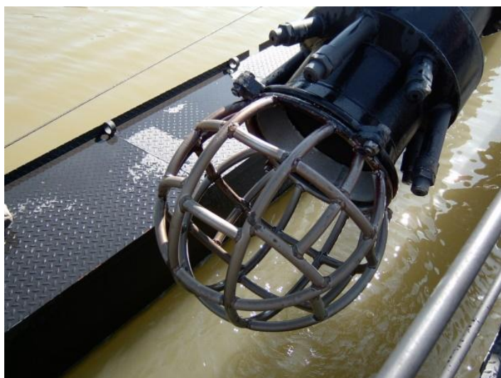
Głowica ssąco-urabiająca z koszem ochronnym.
