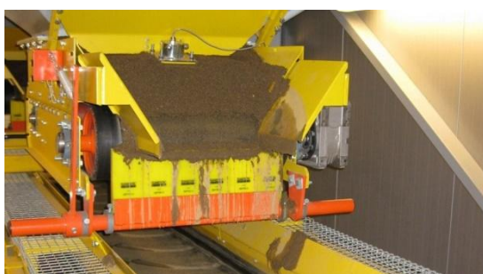
Czujnik na dozowniku taśmowym
