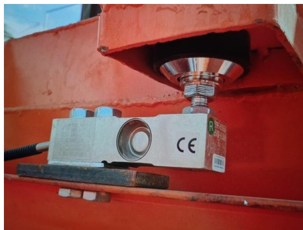
Tensometr wagi cementu.
