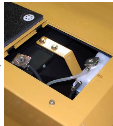
Wskaźnik poziomu oleju hydraulicznego, silnikowego, przekładniowego w zwolnicy oraz płynu chłodzącego.
