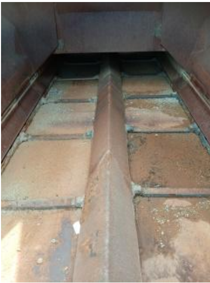
Elementy robocze przenośnika zgrzebłowego.
