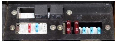
A, B - listwy bezpiecznikowe na pulpicie operatora układarki.
