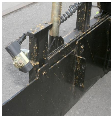
Czujnik ilości mieszanki mineralno-asfaltowej przy przenośniku ślimakowym.
