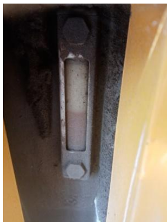
Wskaźnik poziomu oleju hydraulicznego, silnikowego, przekładniowego w zwolnicy oraz płynu chłodzącego.
