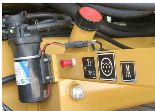
A- kontrolka działania pompy emulsji, B-wyłącznik zasilania pompy emulsji, C-szybkozłącze do podłączania węża.
