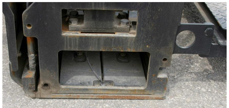
Tamper i płyta gładząca z grzałkami.
