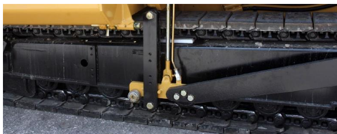
Hydrauliczny mechanizm napinania łańcucha.
