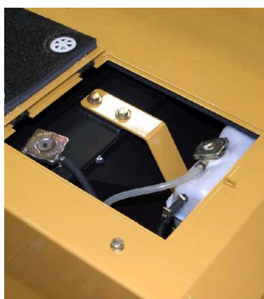
Wskaźnik poziomu cieczy chłodzącej silnika i wody w zbiorniku układu zraszania.
