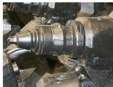
Bęben skrawający z frezami umieszczonymi w uchwytach.
