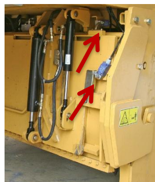
Zabezpieczenia elektryczne i mechaniczne płyty zgarniającej.
