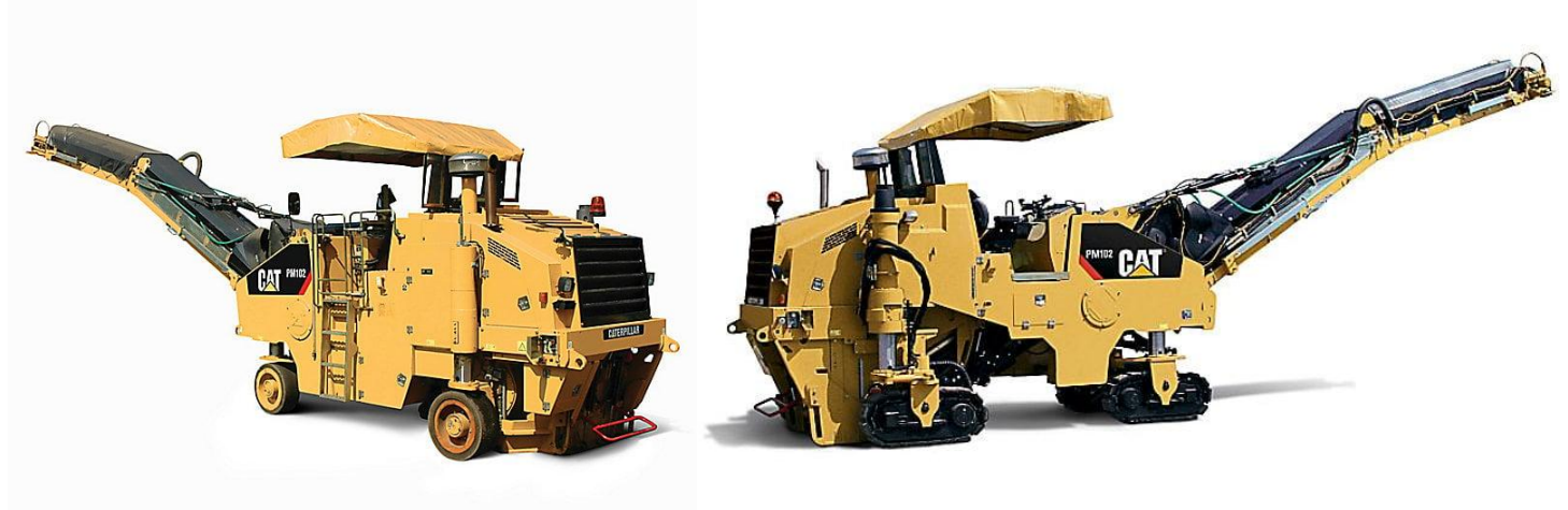
Frezarka do nawierzchni z układem jezdny kołowym i gąsienicowym.
