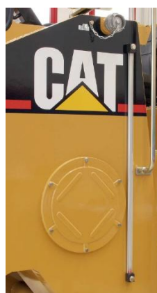
Wskaźnik poziomu cieczy chłodzącej silnika i wody w zbiorniku układu zraszania.
