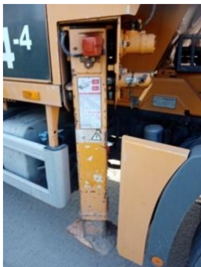
Blokada wysuwu podpory, światło obrysowe podpory, podkłady, kliny pod koła.
