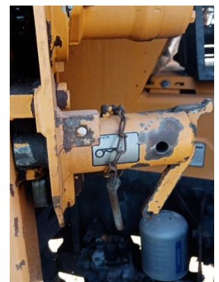
Podpory stabilizujące oparte na podkładach, mechanizm wysuwu podpór, blokada wysuwu podpór.
