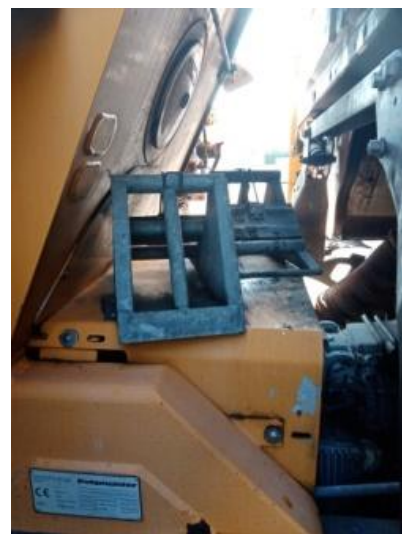
Blokada wysuwu podpory, światło obrysowe podpory, podkłady, kliny pod koła.
