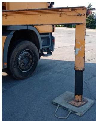
Podpory stabilizujące oparte na podkładach, mechanizm wysuwu podpór, blokada wysuwu podpór.
