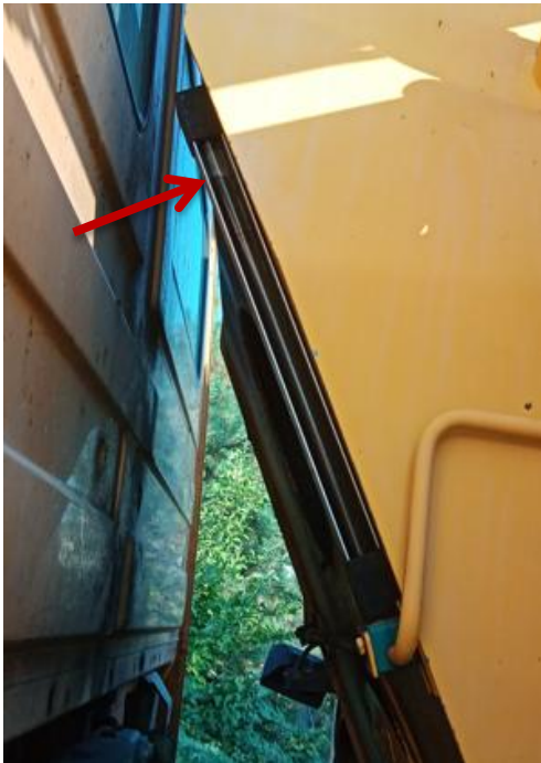
Wskaźnik poziomu oleju i wlew oleju hydraulicznego.
