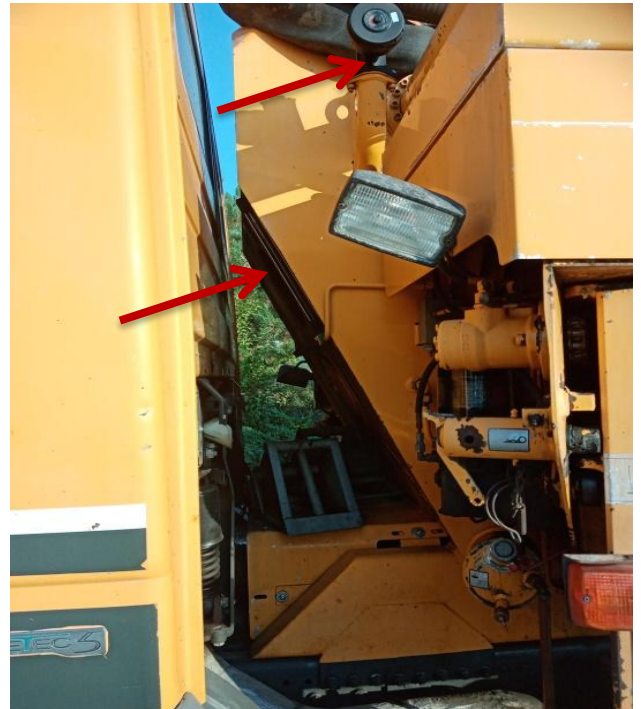
Wskaźnik poziomu oleju i wlew oleju hydraulicznego.
