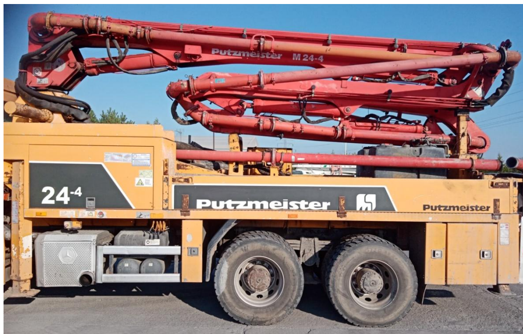
Wysięgnik z rurociągiem tłocznym i podpory pompy w pozycji transportowej.
