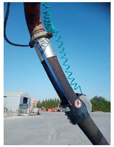
Złącza rurociągu tłocznego, przewód elastyczny rurociągu tłocznego z zaciskiem pneumatycznym.
