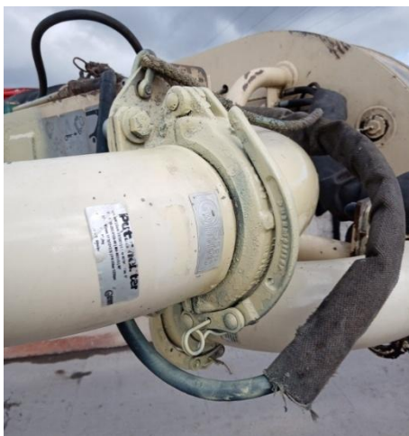
Złącza rurociągu tłocznego, przewód elastyczny rurociągu tłocznego z zaciskiem pneumatycznym.
