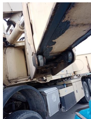
Podpory stabilizujące oparte na podkładach, mechanizm wysuwu podpór, blokada wysuwu podpór.
