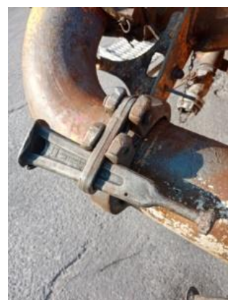
Blokada wysuwu podpory, światło obrysowe podpory, podkłady, kliny pod koła.
