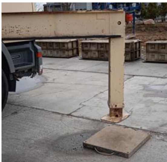
Blokada wysuwu podpory, światło obrysowe podpory, podkłady, kliny pod koła.
