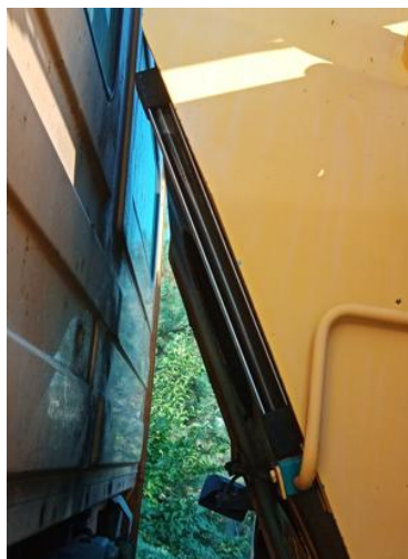
Zbiornik oleju hydraulicznego, chłodnica oleju hydraulicznego, cylinder hydrauliczny z zamkiem hydraulicznym.
