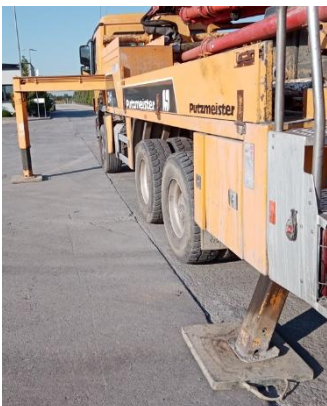
Podpory stabilizujące oparte na podkładach, mechanizm wysuwu podpór, blokada wysuwu podpór.
