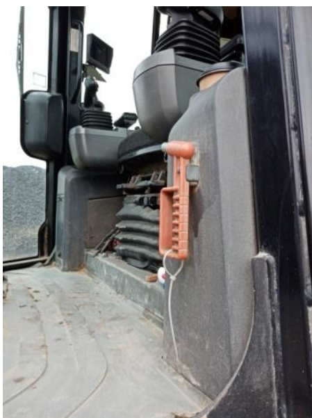
Kabina spycharki mająca drzwi z dwóch stron oraz młotek do zbijania szyb.
