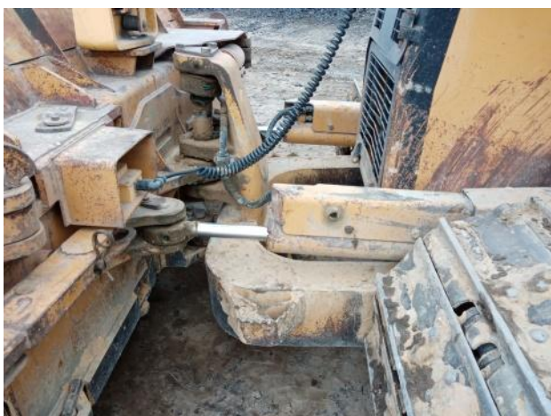
Układ zawieszenia lemiesza spycharki D6K, lemiesz w pozycji transportowej.
