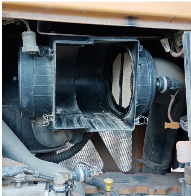
Obudowa filtra powietrza z filtrem bezpieczeństwa i wkład zasadniczy.
