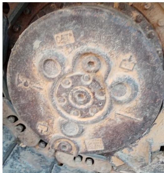
1-korek spustowy, 2- korek kontrolny, 3 –wskaźnik poziomu na obudowie zwolnicy.
