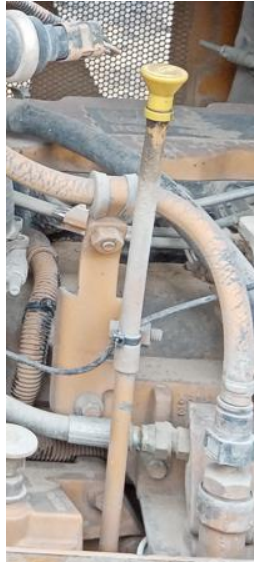
Wskaźniki oleju napędowego, silnikowego, przekładniowego w zwolnicy.
