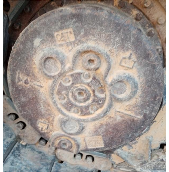
Wskaźniki oleju napędowego, silnikowego, przekładniowego w zwolnicy.
