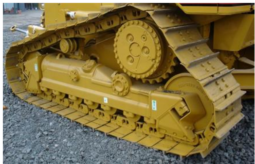
Podwozie spycharki, układ jezdny spycharki gąsienicowej i kołowej.
