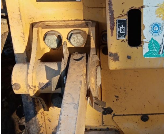
Wskaźnik poziomu oleju hydraulicznego i siłownik regulacji ustawienia lemiesza.
