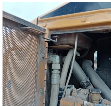
1-korek wlewu płynu, 2-zbiornik wyrównawczy, A-poziom MAX, B-poziom MIN.
