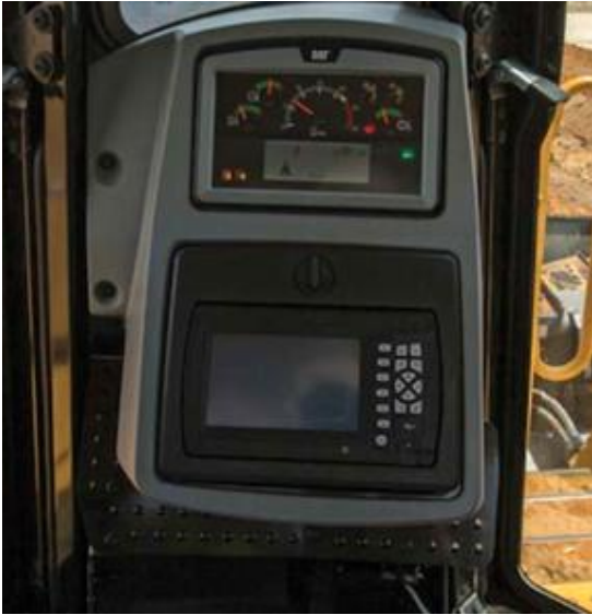
Wskaźniki oleju napędowego, silnikowego, przekładniowego w zwolnicy.
