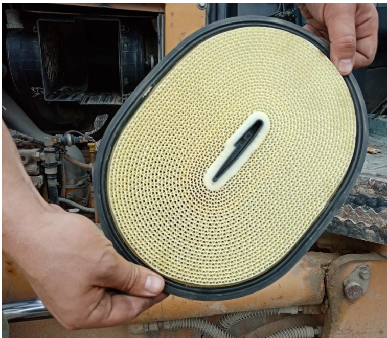
Obudowa filtra powietrza z filtrem bezpieczeństwa i wkład zasadniczy.
