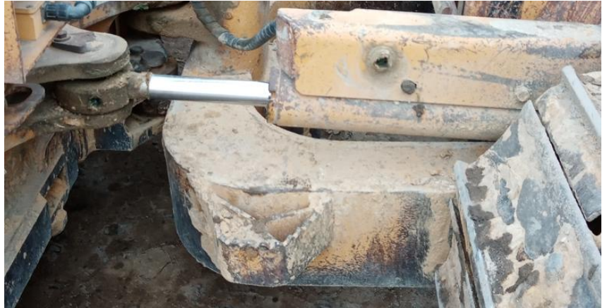
Wskaźnik poziomu oleju hydraulicznego i siłownik regulacji ustawienia lemiesza.
