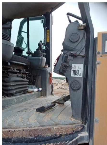
Kabina spycharki mająca drzwi z dwóch stron oraz młotek do zbijania szyb.
