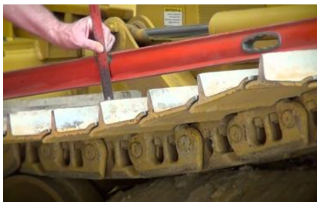
Pomiar zwisu łańcucha łańcucha, zawór służący do napinania łańcucha łańcucha.
