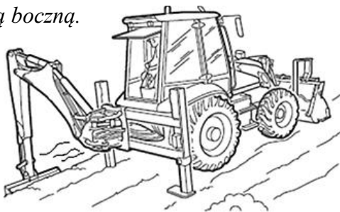
Wykonywanie wykopu metodą czołową i boczną poniżej posadowienia maszyny.
