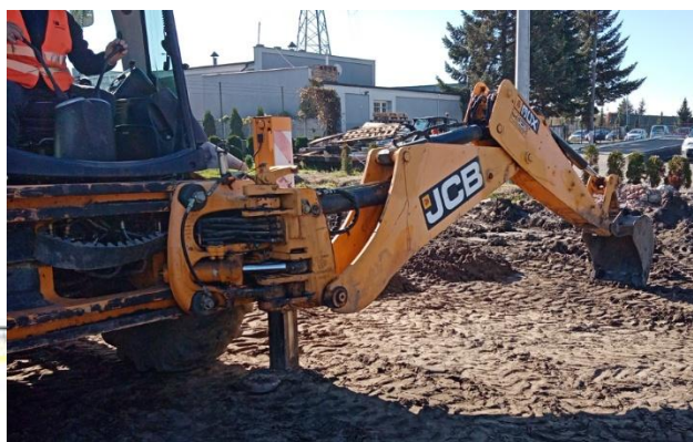
1 – podpory, 2 – wysięgnik, 3 – łyżka osprzętu koparkowego, 4 – ramię wysięgnika.
